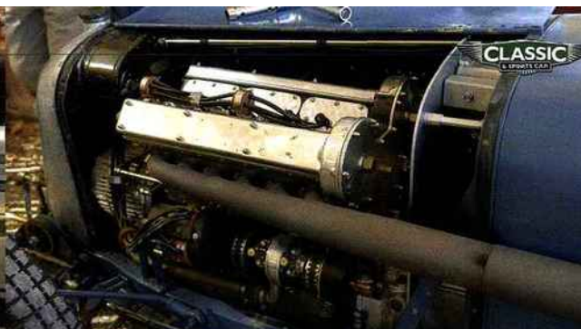
Six cylindres, double ACT, compresseur et transmission décentrée caractérisent cette monoplace Amilcar MCO.
